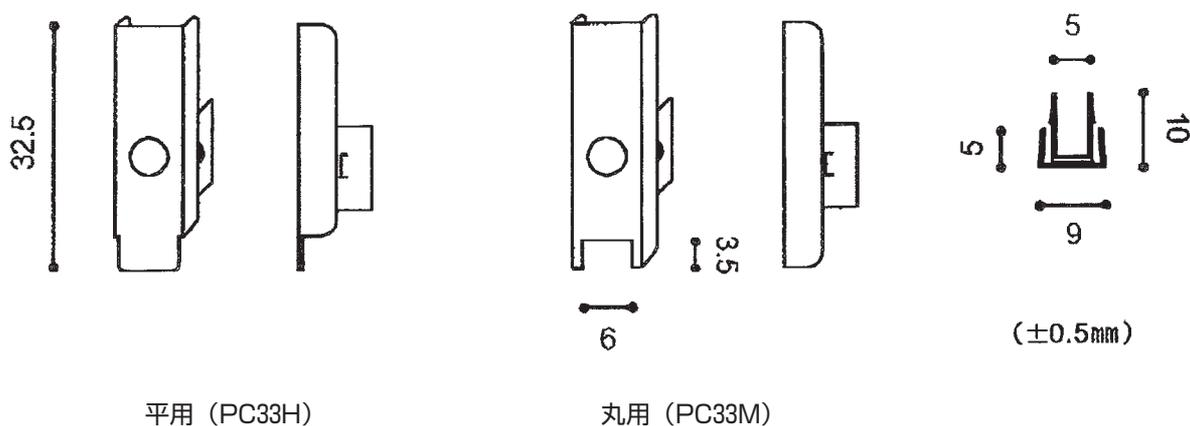
材 質：SUS304 (キャップ) / SUS430 (取付部)
