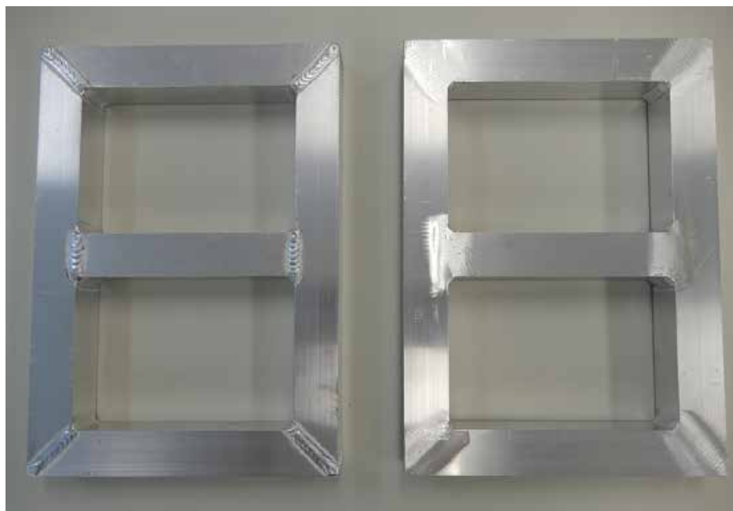
左側は溶接部ビート仕上げ前
